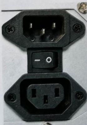
3 EIN-AUS-Schalter eines PC-Netzteils als Stellschalter
