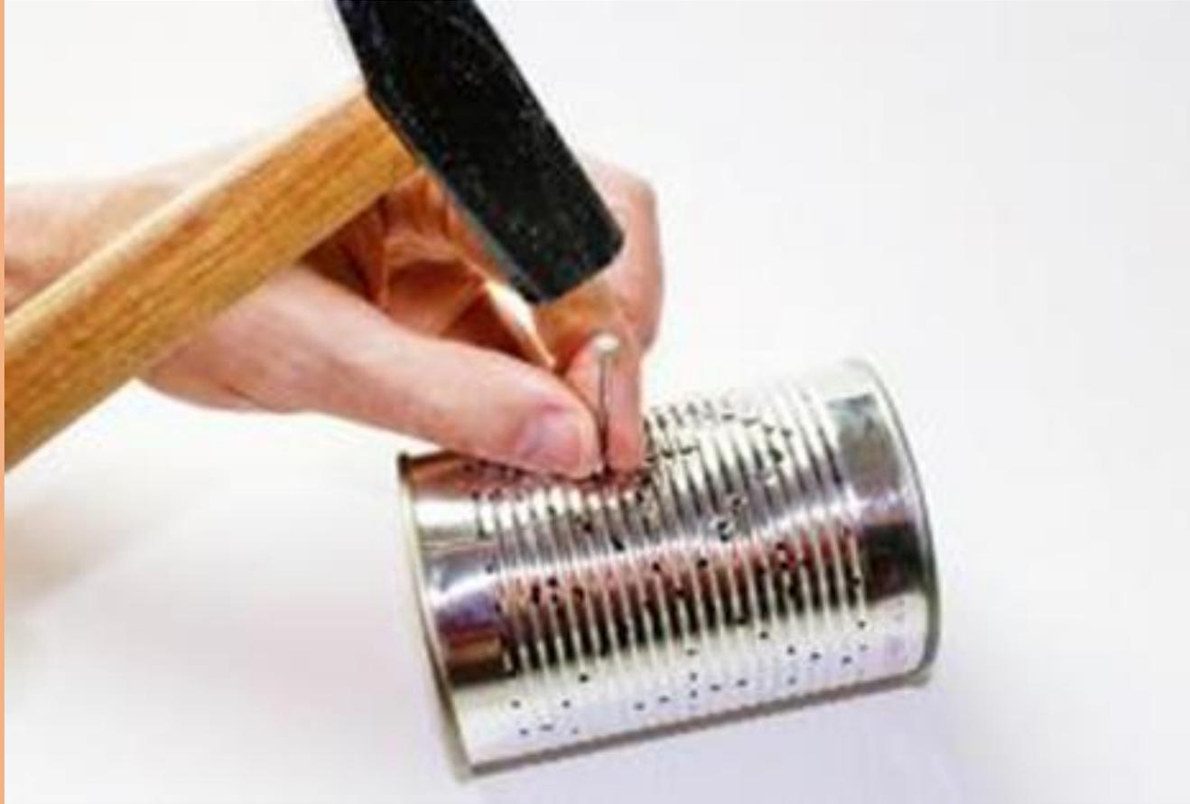
2.: Durchstoßt mit Hammer und Nagel vorsichtig die angezeichneten Löcher. Achtung: Setzt die Löcher nicht zu dicht auf ein und derselben Querrille, die Dose deltt dann ein.
