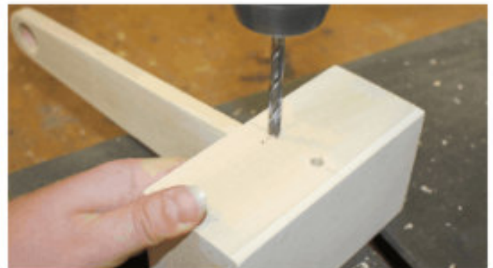
22 Bohren der Dübellöcher für den Griff
