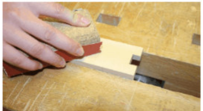
18 Schleifen der Innenseiten
